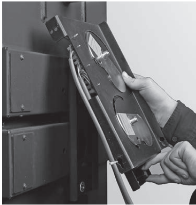
Fig. 26 Accrocher la régulation d'air en haut et la visser en bas
