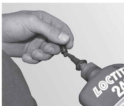
Fig. 24 Ajoutez le frein filet liquide sur la vis à téton
