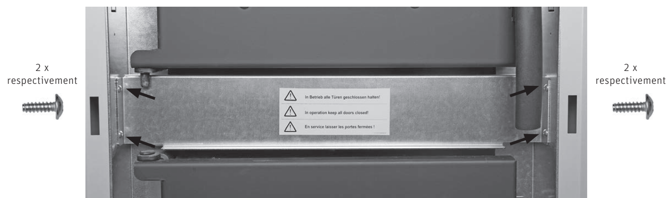
Fig. 53 Visser le couvercle devant la sonde Thermocontrol avec 4 vis
