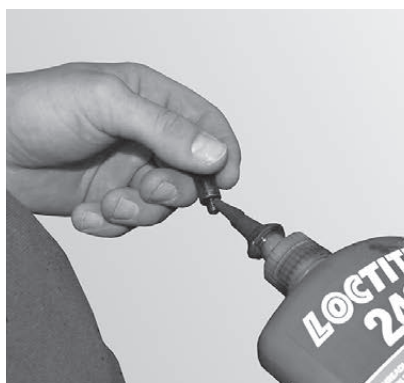
Fig. 16 Ajoutez le frein filet liquide sur la vis à téton
