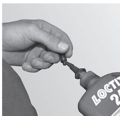
Fig. 19 Ajoutez le frein filet liquide sur la vis à téton
