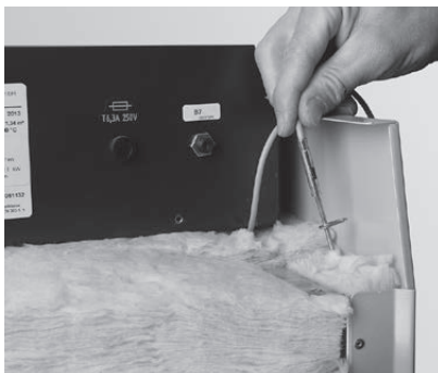
Fig. 54 Insérer la sonde Thermocontrol en haut
