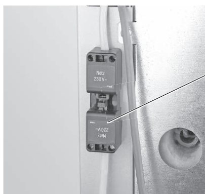
Fig. 91 Brancher ou raccorder la fiche secteur
