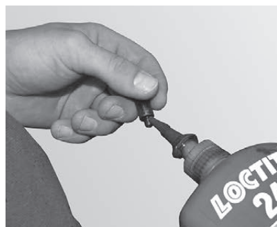
Fig. 29 Ajoutez le frein filet liquide sur la vis à téton
