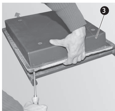
Fig. 17 Retirer le vantail de porte complet et le revisser tourné de 180°
