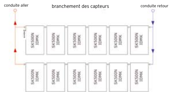
Branchement en série (6 capteurs maxi) et branchement de capteurs en parallèle sans boucle de Tichelmann (déconseillé)
