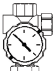
Clapet anti-retour ouvert en position 45°
