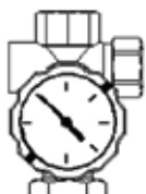
Clapet anti-retour ouvert en position 45°
