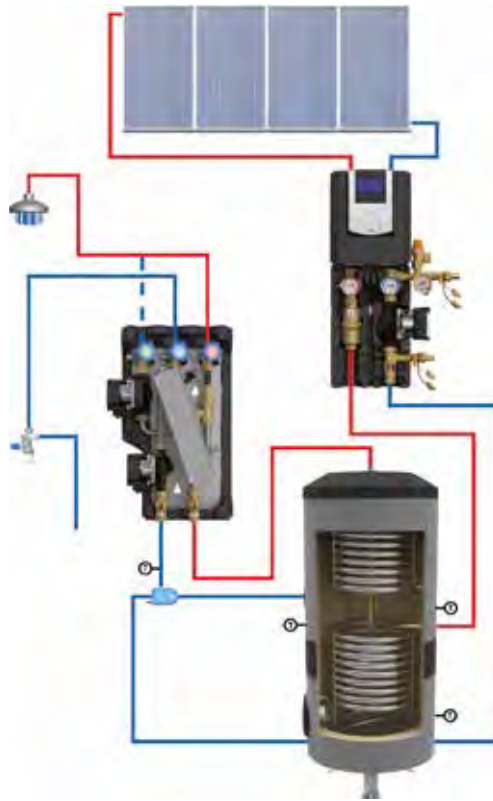
Exemple de montage SolarBloC midi Basic en combinaison avec une FriwaMini avec circulation intégrée
