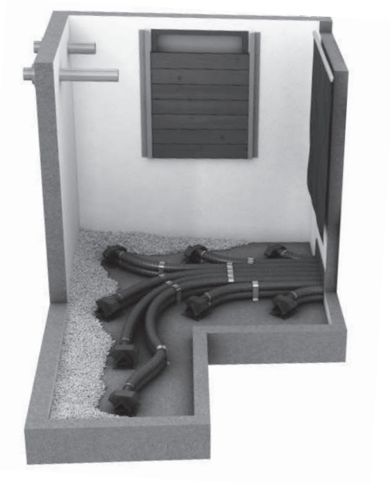
Fig. 29 Silo sans plan incliné
