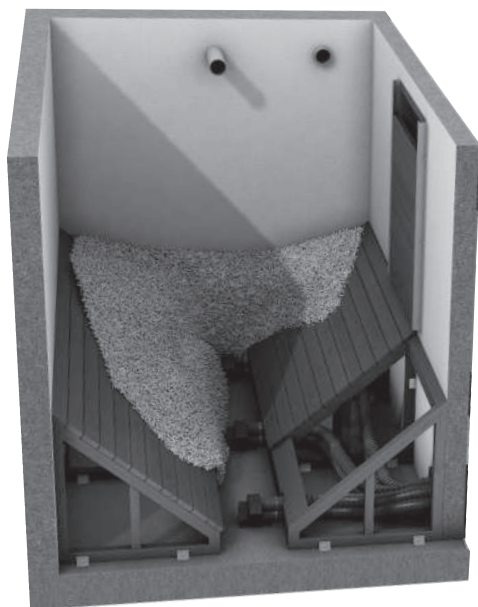
Fig. 28 Silo avec plans inclinés
