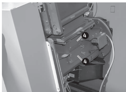
Fig. 131 Couvercle de maintenance au niveau de la vis sans fin du stocker
