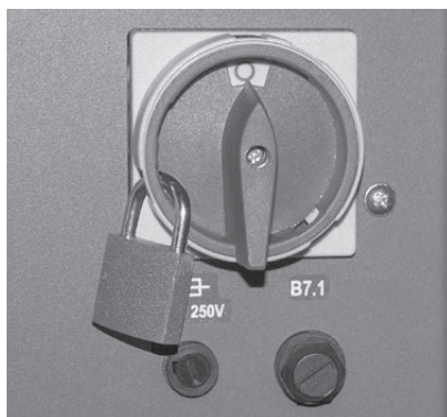
Fig.2 Mettre l'interrupteur principal en position « 0 » et le sécuriser contre toute remise en circuit à l'aide d'un cadenas
