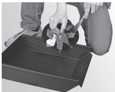
Fig. 36 Nettoyer la roue du ventilateur
