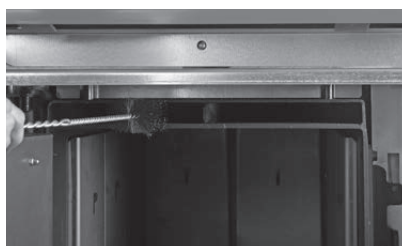
Fig. 33 Nettoyer le système d'aspiration des gaz
