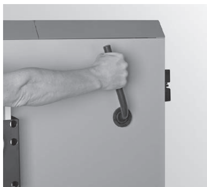
Fig. 51 Activer le levier de nettoyage des surfaces d'échange 5 à 10 fois – LogWIN Klassik
