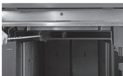
Fig. 56 Nettoyer le système d'aspiration des gaz
