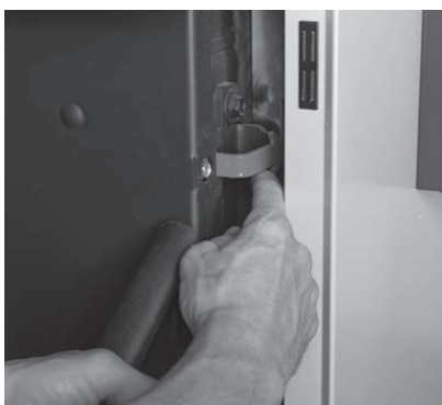
Fig. 41 Ouverture du verrouillage de la porte de remplissage
