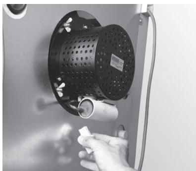
Fig. 58 Débrancher le connecteur du ventilateur et retirer les écrous à oreilles
