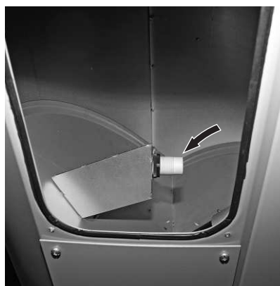
Fig. 71 Commutateur capacitif de l'unité d'alimentation
