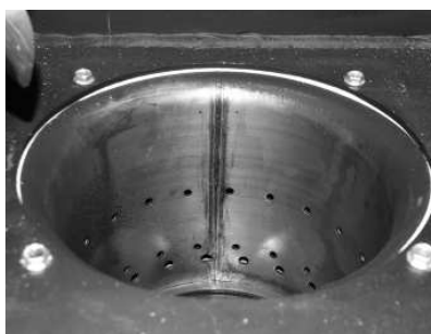
Fig. 49 Nettoyer les volets d'air secondaire dans le creuset du brûleur
