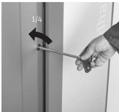
Fig. 6 Ouverture de la porte du revêtement à l'aide d'une clé à six pans creux
