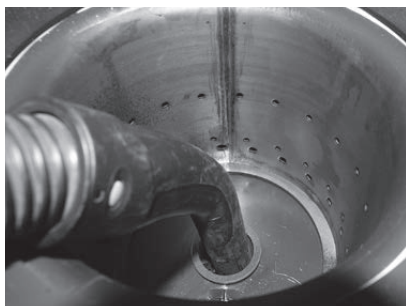
Fig. 51 Aspirer aussi les cendres du tube d'air primaire au milieu du creuset de brûleur
