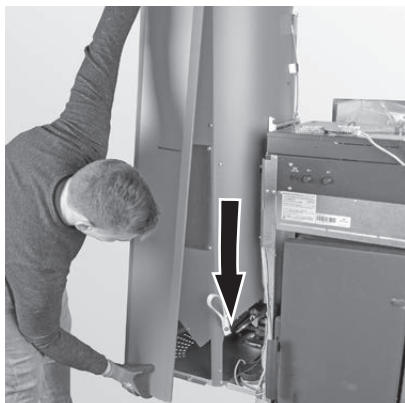
Fig. 71 Pousser le cache vers le bas et l'enlever (fermeture à baïonnette)
