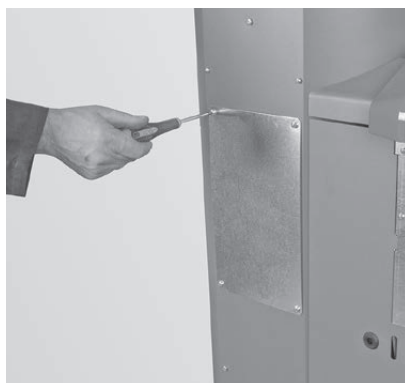
Fig. 75 Enlever les vis, retirer le couvercle de révision
