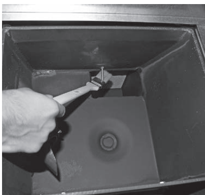
Fig. 44 Nettoyage de la sonde Thermocontrol
