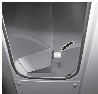
Fig. 77 Commutateur capacitif de l'unité d'alimentation
