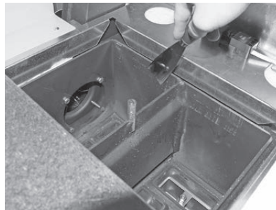
Fig. 64 Nettoyer les surfaces d'échange
