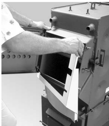
Fig. 11 Insérez la paroi avant par le bas
