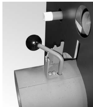
Fig. 10 Montez le bouton sphérique et le mécanisme d'arrêt
