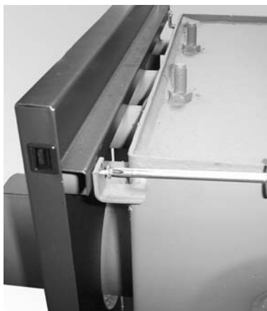
Fig. 9 Serrez la paroi arrière avec 2 vis
