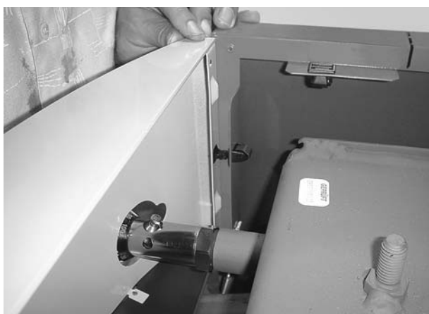
Fig. 22 Enclenchez les fermail de la jaquette avant dans les écrous à déclic
