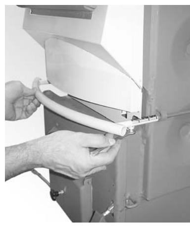
Fig. 16 Montez la barre de commande sur le tiroir d'air secondaire
