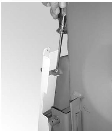
Fig. 12 Fixez la paroi avant en haut avec 2 vis
